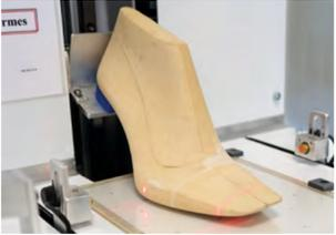
> 2015 / Machine de contrôle de géométrie de formes
