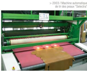
> 2003 / Machine automatique de tri des peaux "Selectra"
