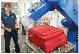
> 2015 / Tests de vieillissement et d'endurance simulés des conditions d'usage à l'aide de la robotique
