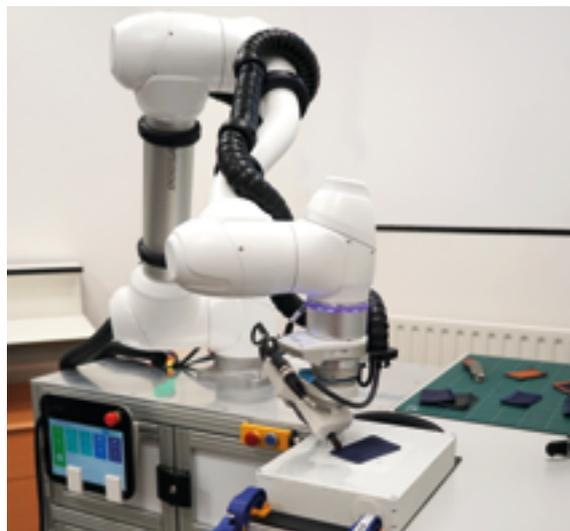
Pour les métiers de la maroquinerie, 2020 marque l'arrivée d'un robot collaboratif dans les ateliers. L'objectif prioritaire a consisté en une étude de faisabilité sur l'intégration d'un robot collaborant avec le maroquinier afin de l'assister dans les tâches qu'il effectue quotidiennement. Ce robot doit être la troisième main de l'opérateur et pouvoir travailler au contact de l'homme pour diminuer la pénibilité et améliorer la précision.
