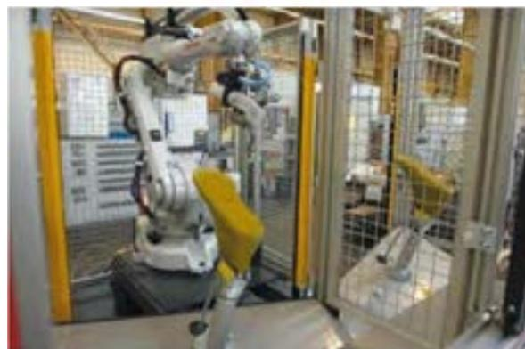
Cellule de cardage robotisée
