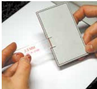
Figure 6 : contrôle de la largeur de piqûre
