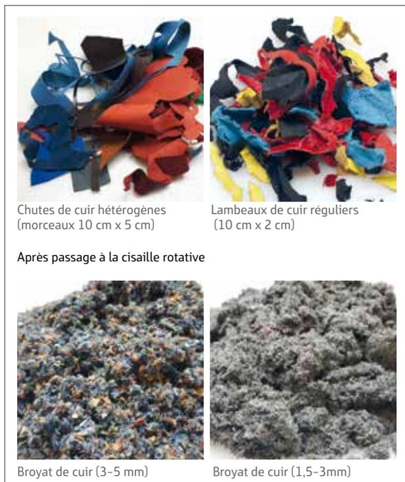
Figure 1 : chutes de cuir avant et après broyage
