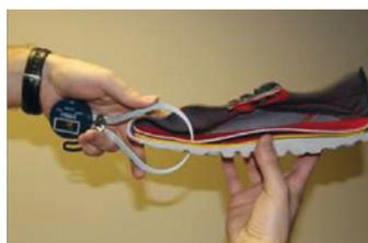
Figure 2 : présentation d'une méthode pour déterminer le drop d'une chaussure
