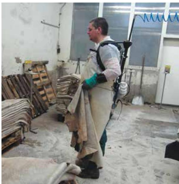
L'exosquelette est relié au réseau d'air comprimé (Tanneries Haas)
